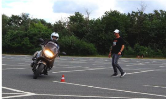
machte die Gefahrenbremsung. Schnell auf dem kurzen Weg des Parkplatzes auf 60 km/h beschleunigt und dann ab der ersten Pylone alles an Bremskraft auf den Boden bringen was die Maschine hergibt. Hierbei kam es vor Allem auf die Körperspannung und die richtige Blickführung an. Die knapp 250 kg Leergewicht meiner Deauville drückten dabei ordentlich gegen das Abbremsen an, konnten die drei Scheibenbremsen mit ABS aber nicht davon abhalten, die Maschine in kürzester Zeit zum Stehen zu bringen.
